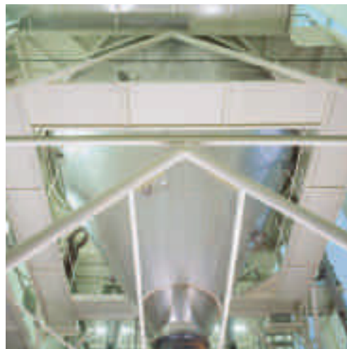
Traypacker und Palettieranlage (links). Im Sprühturm werden die Zutaten für die Cappuccino-Produkte getrocknet (rechts). Tray packer and palletisation (left). The ingredients for cappuccino are dried in the spray tower (right).
