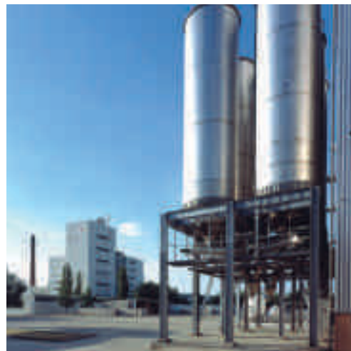
Ökologie wird in der Produktion beachtet und der Kaffeesatz zur Energierückgewinnung in den Kesseln verbrannt (links). Blick vom Produktionsgebäude II zum Hauptwerk (rechts). In the interest of environment and energy conservation waste coffee grounds are recycled to feed the boilers (left). View from the production plant II to the main plant (right).
