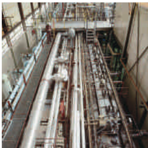
Erfahrene Röstmeister überwachen den je Charge festgelegten Röstvorgang. Im Vakuumtunnel wird dem tiefgefrorenen Kaffeekonzentrat schonend das Wasser entzogen. Experienced roasting experts monitor the roasting process defined for each batch. In the vacuum tunnel the water is extracted gently from the frozen coffee extract.
